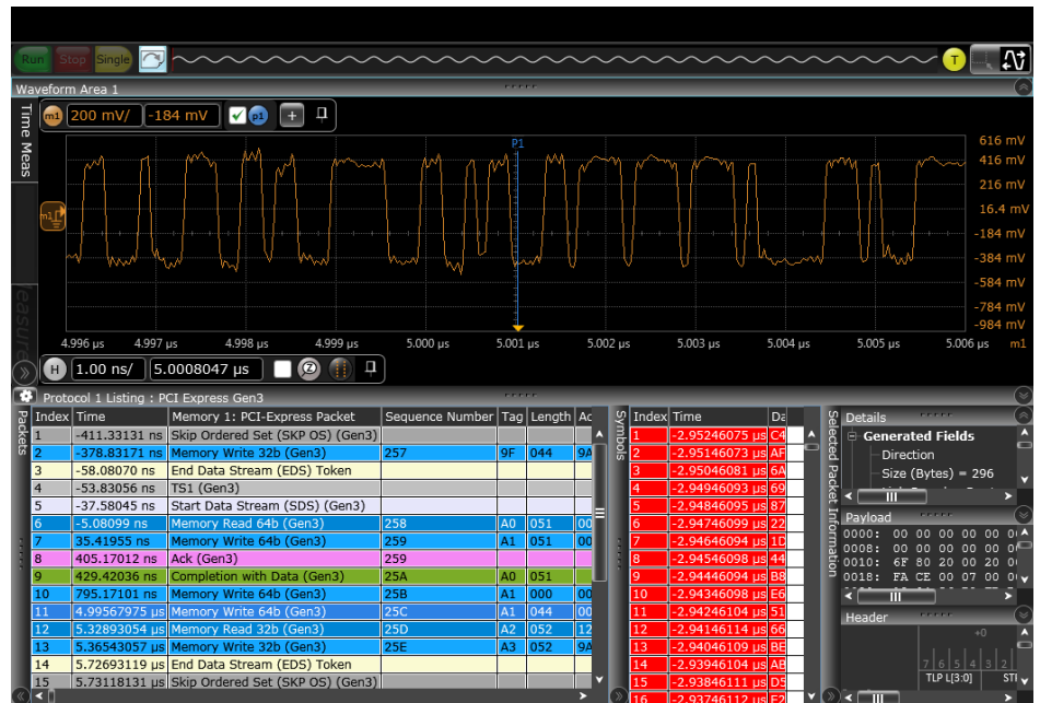
Осциллограф серии Z, декодирующий пакеты PCI Express Gen3.
